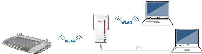
Verbinden Sie FRITZ!Powerline 540E über die WLAN-Brücke mit Ihrem Internetrouter, wenn Sie die WLAN-Reichweite des Routers vergrößern wollen oder wenn Sie Netzwerkgeräte mit LAN-Anschluss über WLAN erreichen wollen.
