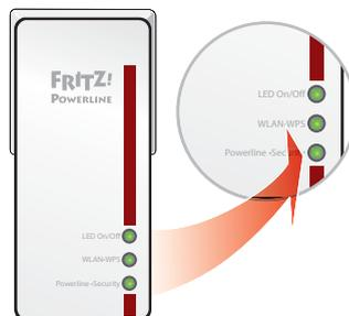
3. Drücken Sie am zweiten Powerline-Adapter den Taster, der für die sichere Powerline-Verbindung vorgesehen ist. Der Taster ist mit „Security“, „Powerline“ oder ähnlich beschriftet.
