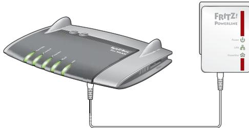
5. Verbinden Sie den zweiten Powerline-Adapter mit einem Netzwerkkabel mit der FRITZ!Box.
