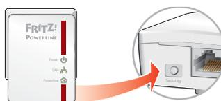
Sobald die Leuchtdiode „Powerline • Security“ an FRITZ!Powerline 540E dauerhaft leuchtet, ist das Powerline-Netzwerk eingerichtet.
